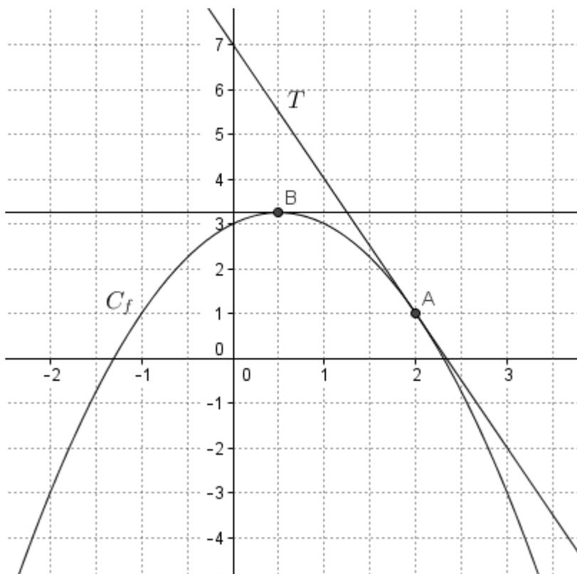
La droite  $T$  est la tangente à la courbe  $C_f$  au point  $A(2 ; 1)$  et elle passe par le point de coordonnées  $(0 ; 7)$ .
